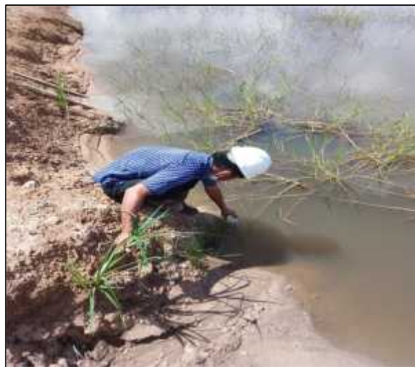
Gambar 4.7. Pengambilan Sampel Air pada Kolam Pengendap Lumpur Terakhir (Outlet)
