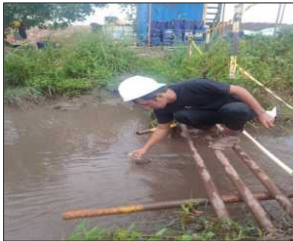
Gambar 4.5. Pengambilan Sampel Air pada Saluran Inlet
