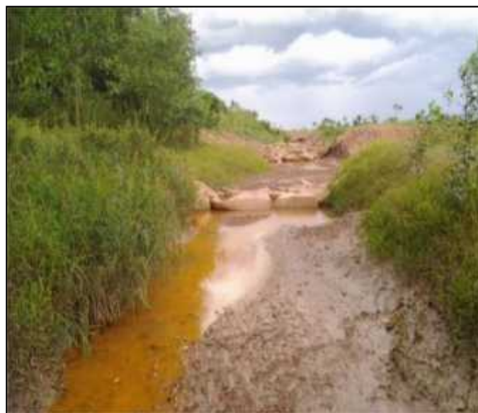
Gambar 3.1. Endapan Oksida/Hidroksida Besi Berwarna Merah pada Dasar Saluran Air dengan pH Air Sangat Asam
