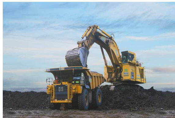
Gambar 3.3 Pola Muat Top Loading
