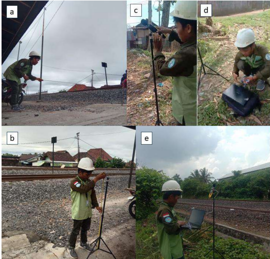
Gambar 1. Mengukur jarak dari rel ke titik pantau (a) mengukur ketinggian tripod (b) memasang alat SLM ke tripod (c) mempersiapkan kabel dan laptop untuk disambungkan ke alat SLM (d) melakukan pemantauan terhadap tingkat kebisingan (e).
