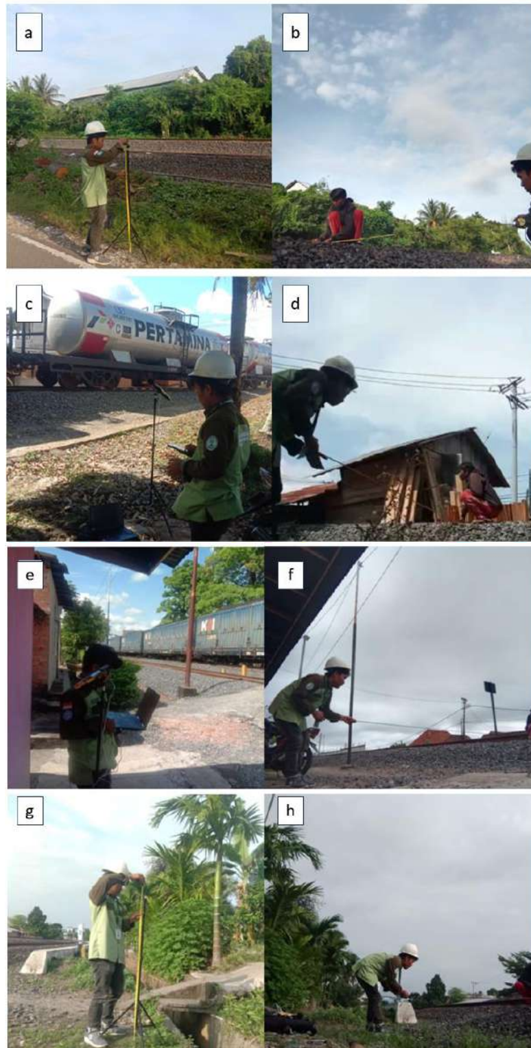
Gambar 2. Lokasi penelitian di Kelurahan Kebun Duren (mengukur ketinggian tripod (a) dan mengukur jarak dari rel ke titik pengukuran (b), Majasari (pemantauan dan mencatat nilai tingkat kebisingan (c) dan pengukuran
