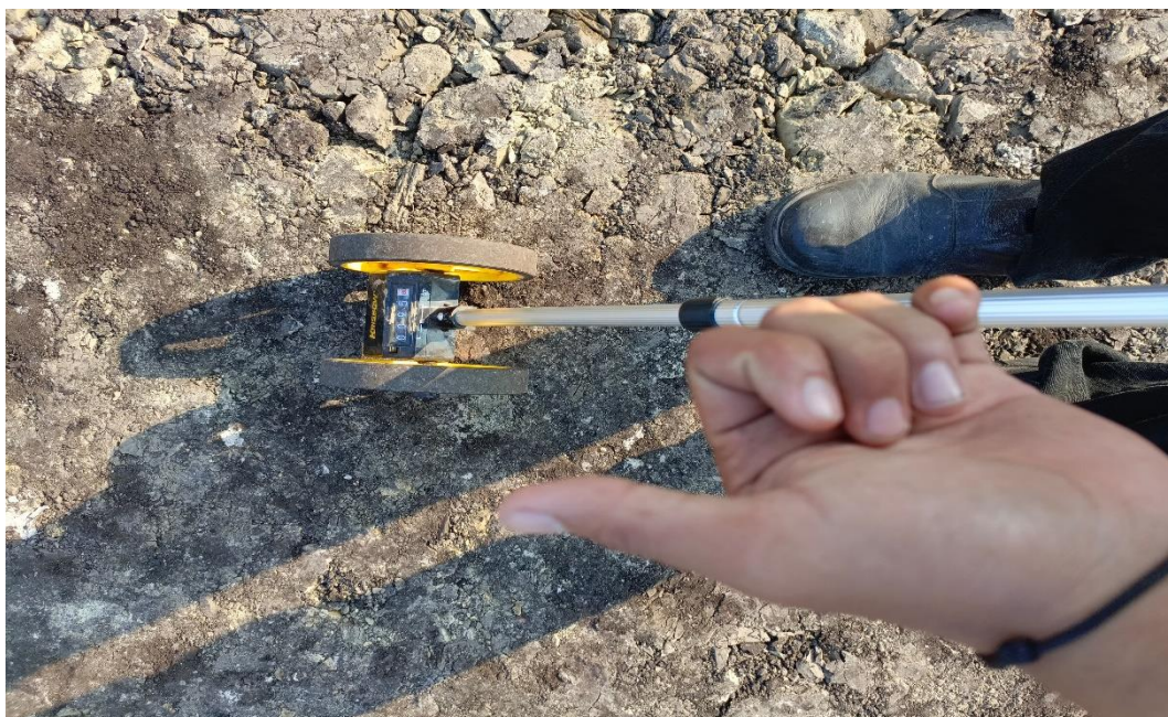
Gambar B.2 Pengukuran Menggunakan Meteran Roda
