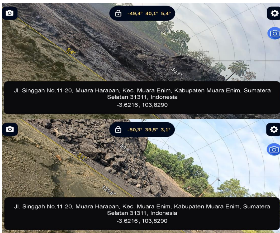
Gambar B.4 Pengukuran Sudut Timbunan Bervariasi dari 40°-50°
