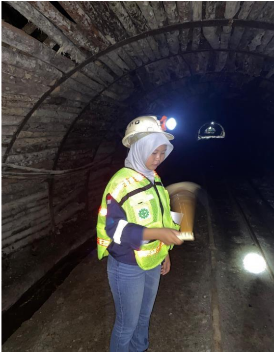
Gambar G.3 Pengukuran Suhu Menggunakan Alat Sling Psychrometer
