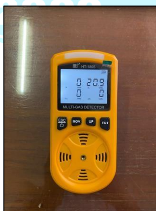
Gambar 4.7 Hasil Pengukuran Konsentrasi Gas Tambang Menggunakan alat gas detektor pada Lokasi Pengamatan
