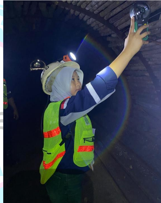
Gambar G.2 Pengukuran Kecepatan Angina Menggunakan Anemometer
