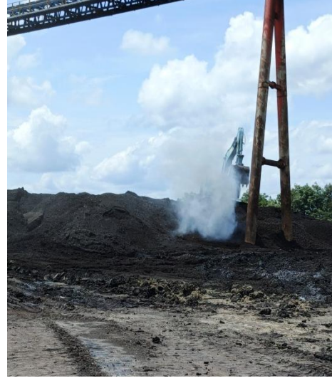
Gambar L.6 Proses evakuasi terjadinya swabakar pada tumpukan
