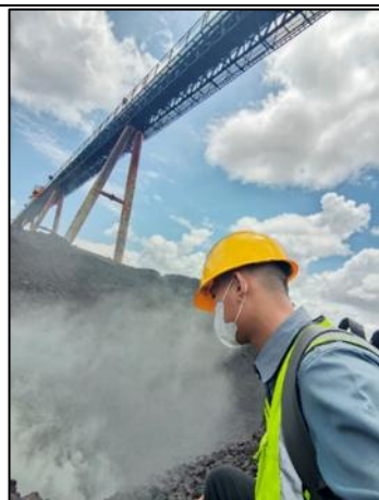
Gambar L.4 Pengamatan saat terjadi swabakar pada timbunan batubara
