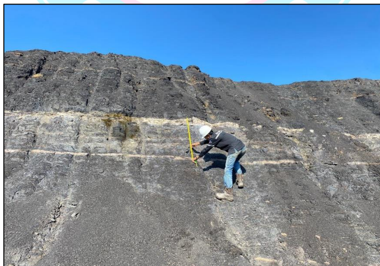
Gambar 4.1 Pengukuran Material Parting di Seam AU
