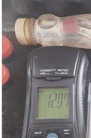
Gambar A. 5 TSS Outlet Sebelum Maintenance
