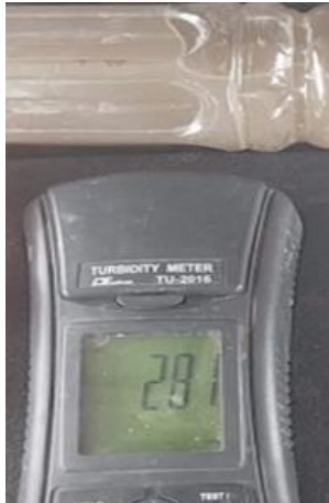
Gambar A. 1 TSS Inlet Sebelum Maintenance
