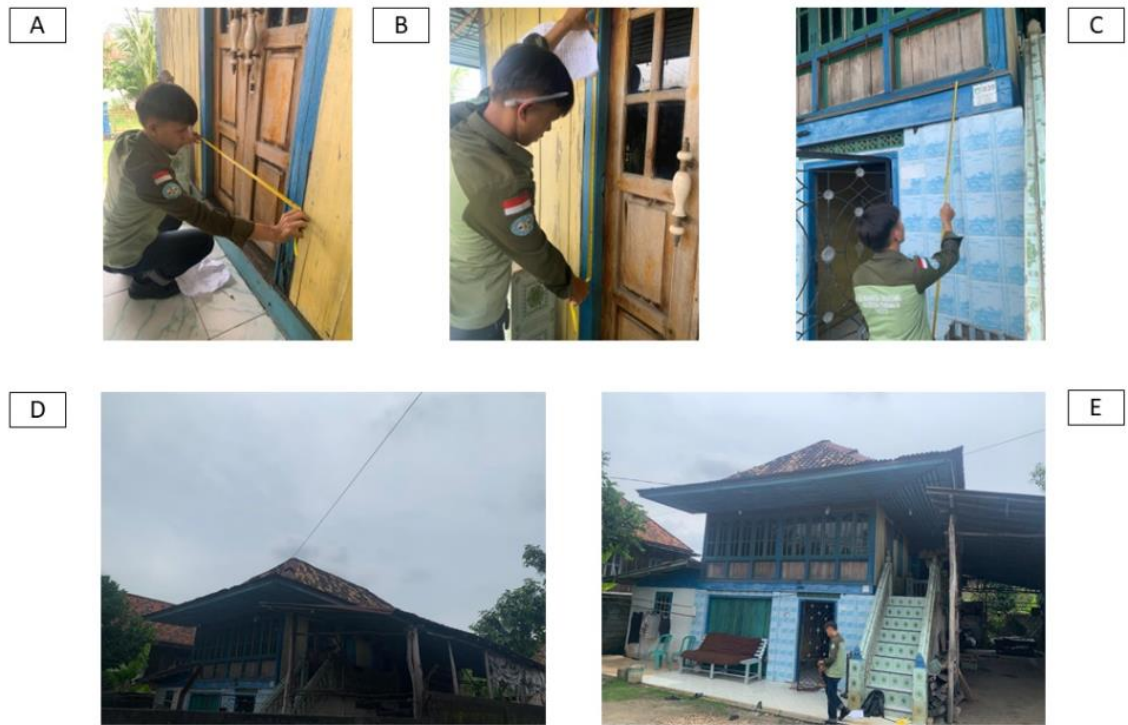
Gambar 1. Pengukuran rumah atap limas lebar pintu depan (A), tinggi pintu depan (B), lisplang (C), belakang rumah (D), dan lebar rumah (E).
