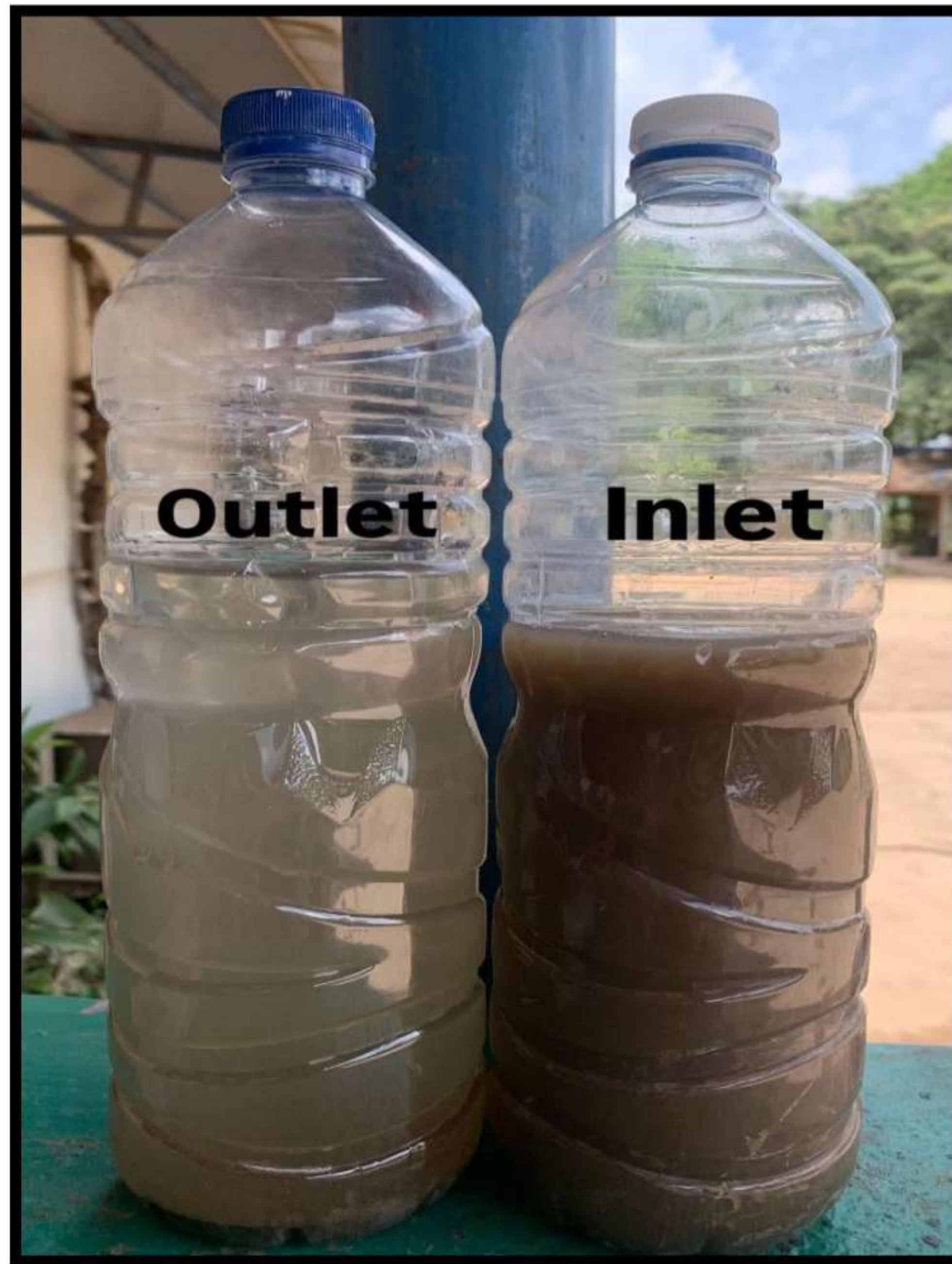
Gambar C.6. Perbandingan Air Asam Tambang di Inlet dan Outlet KPL Main Sump 2
