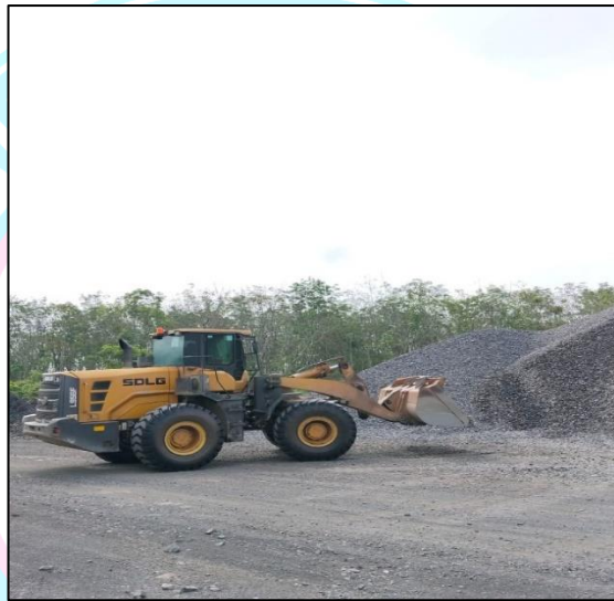
Gambar 4.4 Penggalian Material oleh Wheel Loader SDLG L956F
