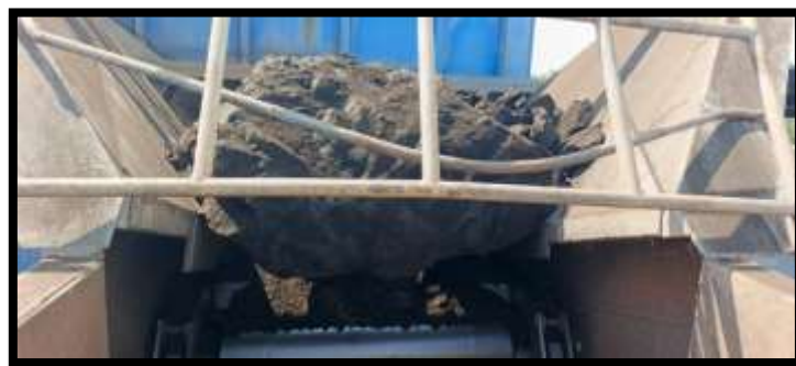
Gambar 4.4 Kondisi Batu Yang Menumpuk Di Hopper
