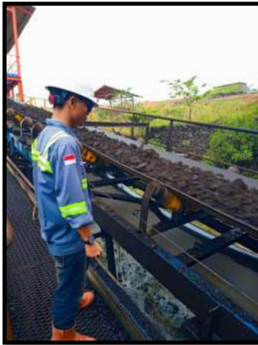
Sumber : Penulis, (2025) Gambar E.2 : Pengiriman Batubara Ke Transfer Conveyor
